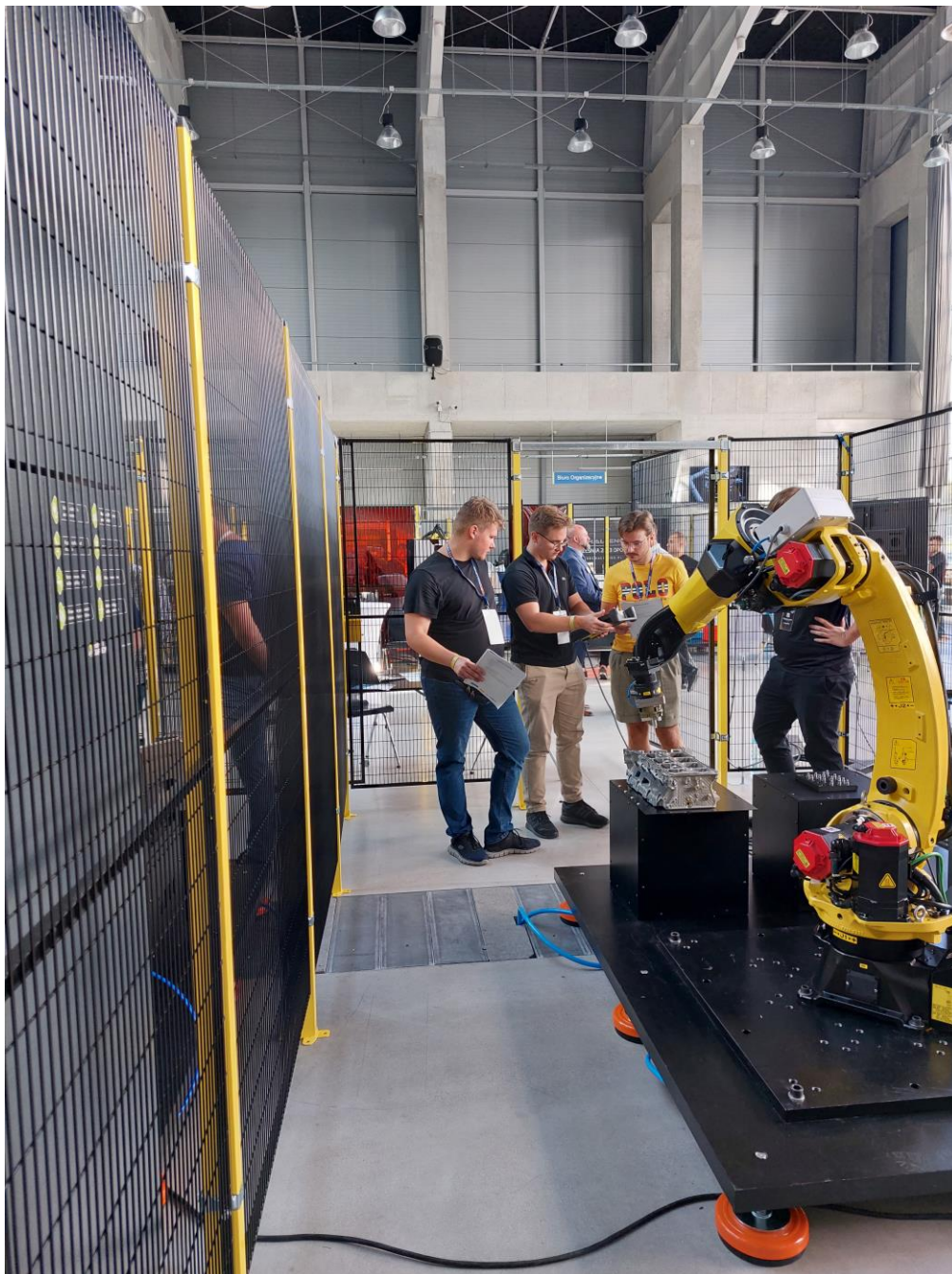
Zespół podczas rywalizacji – kolejne zadanie podczas konkursu (Montaż głowicy silnika – robot 6 osiowy z sensorami siły)
