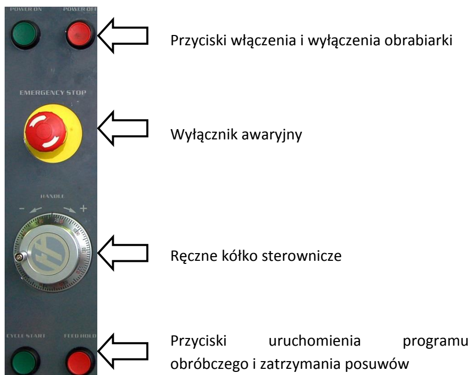
Rys. 2. Opis przycisków na panelu sterowniczym HAAS
