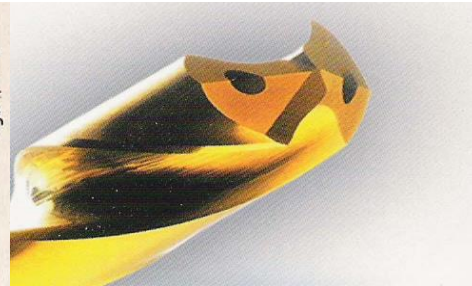
rys. 10.1. Schemat ostrzenia wiertel krętych metodą trójpłaszczyznową
